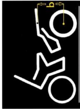
b) Messen Sie den Abstand von einem bestimmten Punkt, z.B. einer Schraube, oder markieren Sie einen Punkt mit einem Stück Klebeband über der Hinterradachse.
