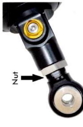
Prüfen Sie, ob sich das Hinterrad des Fahrzeugs frei drehen lässt, wenn Sie die längste mögliche Einstellposition nutzen.
